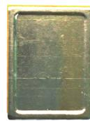
Мощные высоковольтные полевые транзисторы в металлокерамических корпусах, предназначенные для использования в современных и перспективных источниках вторичного электропитания, в узлах и блоках преобразовательных устройств и в другой аппаратуре широкого применения, изготавливаемой для народного хозяйства.
